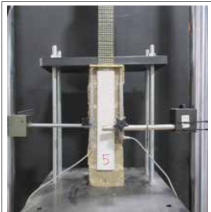
Fig.5: Prova di distacco dal supporto per un composito FRCM
