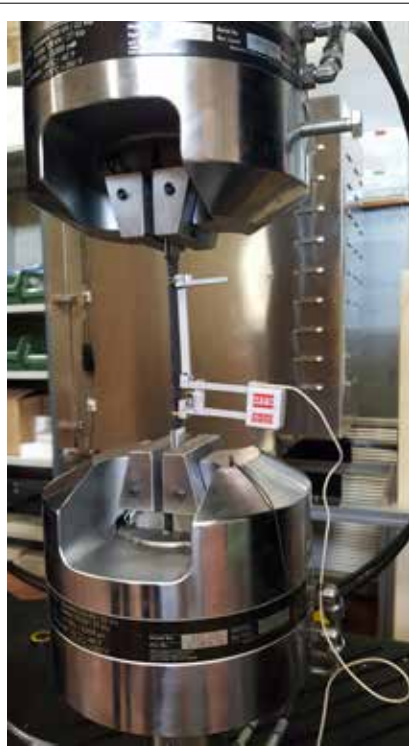
Fig.2: Determinazione della resistenza a trazione di un composito FRP impregnato in situ
