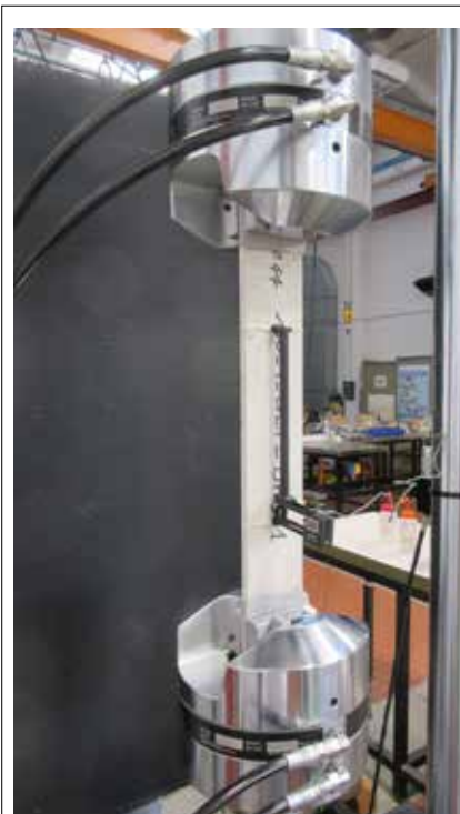
Fig.3: Determinazione della resistenza a trazione di un composito FRCM
