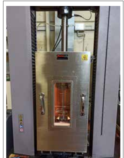
Fig.4: Prova in temperatura di un composito FRCM
