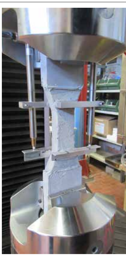
Fig.7: Prova di trazione su calcestruzzo fibrorinforzato
