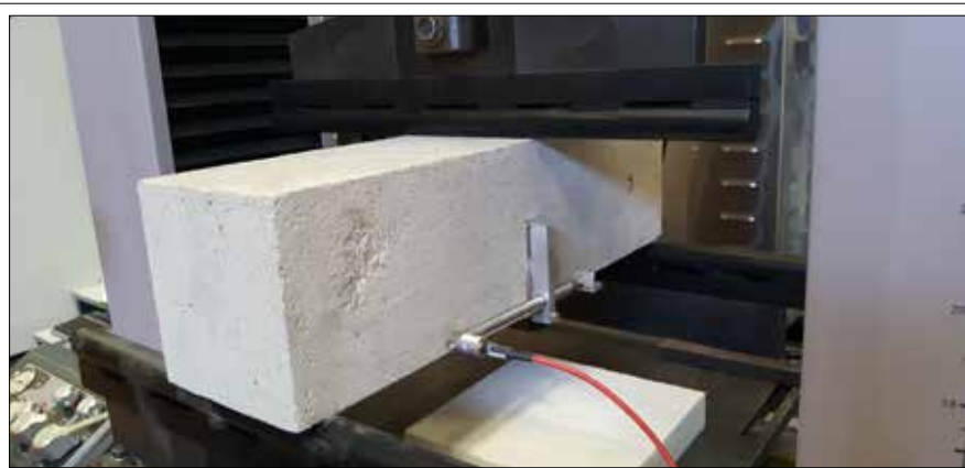
Fig.8: Prova di flessione su calcestruzzo fibrorinforzato
