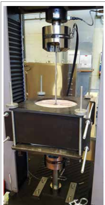
Fig.6: Prova di estrazione di un connettore dal supporto murario
