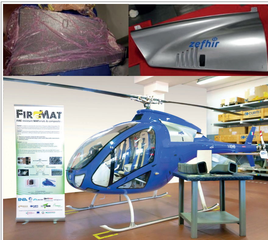
Fig.5: Processo di laminazione e risultato finale del dimostratore del cofano motore per l'elicottero Zefhir
