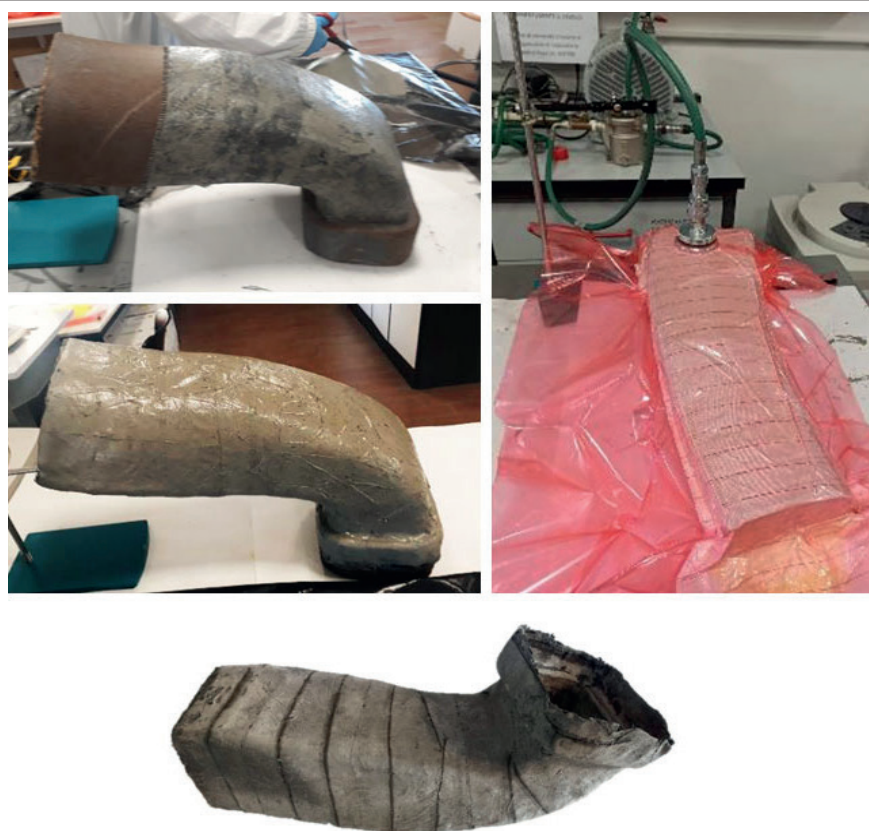
Fig.7: Dimostratore in scala reale di un tubo di scarico di un elicottero e sua produzione
