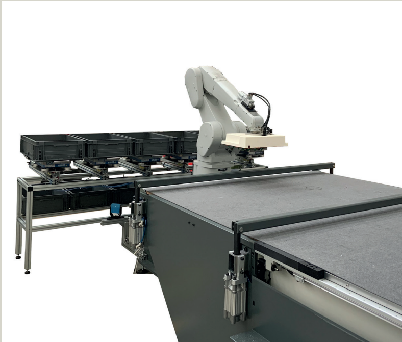
Fig.2: Sistema Hypercut per automatizzare la raccolta, la suddivisione e la creazione di kit
