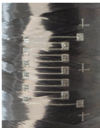
Fig.1: Particolare del sensore stampato su superficie realizzata in filament winding
